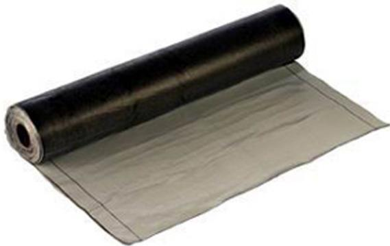
La formulación de esta membrana, permite que frente a perforaciones accidentales realizadas en obras, perforaciones del tipo punzamiento, o bien, un corte tipo cuchillo, ésta sea capaz de autosellarse por sí sola, es decir, mantiene siempre vigente la condición de autorreparación, propiedad inherente entregada por las arcillas que la componen debido a la capacidad que tienen las mismas de expandirse.
