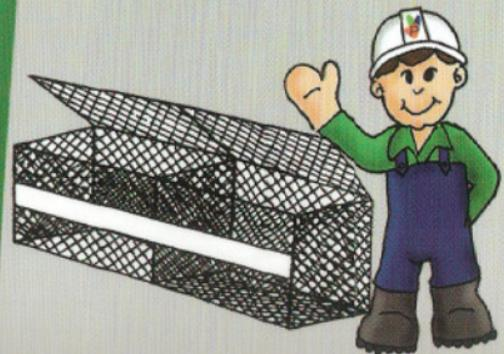
Usar tablas para disminuir la posibilidad de deformación de las caras exteriores del gavión durante el llenado.
